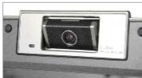
Поворотная камера в крышке ноутбука Asus расширяет мультимедийные возможности мобильного ПК
